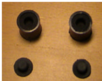
Figura 4: Silemblock después de soportar un desenganche
