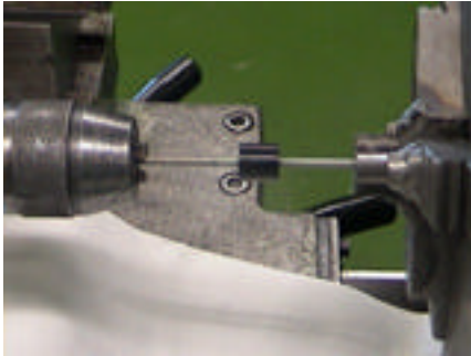
Figura 1: Sistema de la prueba Torno-Silemblock
