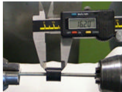
Figura 2: Longitud inicial del Silemblock
